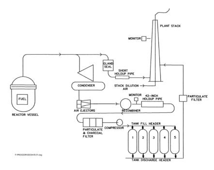
FIGURE 3: GASEOUS RADWASTE TREATMENT SYSTEM AT MNGP.
