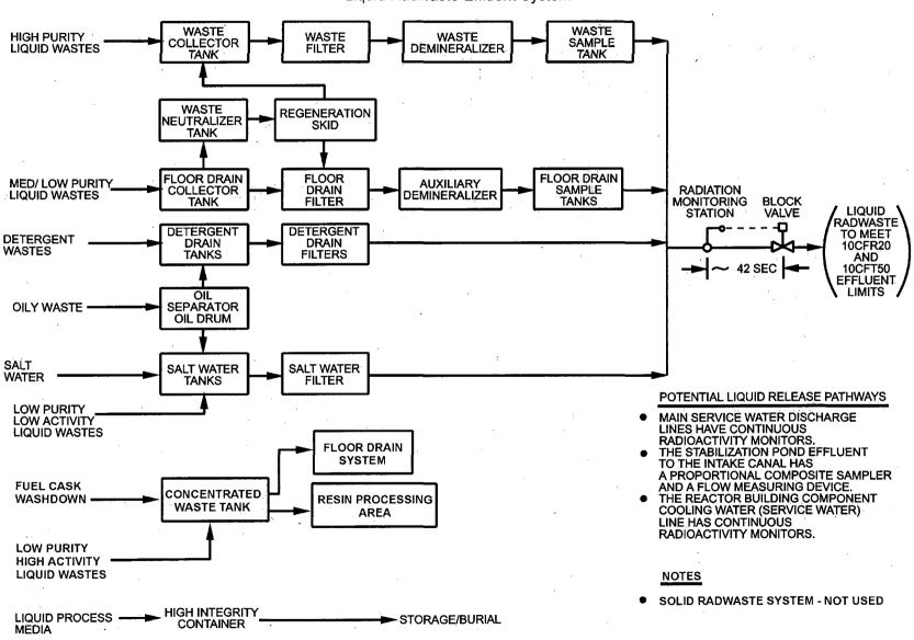
Liquid Radwaste Effluent System
